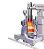
Spillaggio acciaio liquido in siviera e trasferimento alle postazioni per i trattamenti metallurgici secondari Forni siviera, LF e LF-Twin, e impianto di degassaggio sottovuoto, VD
